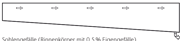
Sohlgefälle (Rinnenkörper mit 0,5 % Eigengefälle)
